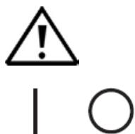
Les blocs d'alimentation pour l'instrument TriPlus RSH/TriPlus 100 LS et le Temperature Controlled Drawer comprennent les symboles I/O sur l'étiquette de l'interrupteur pour indiquer MARCHE/ARRÊT.
