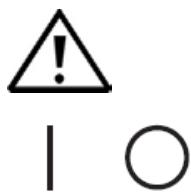
Las fuentes de alimentación para el Sistema TriPlus RSH/TriPlus 100 LS y el módulo Temperature Controlled Drawer muestran los símbolos I/O en el interruptor de alimentación para indicar "encendido"/ "apagado".
